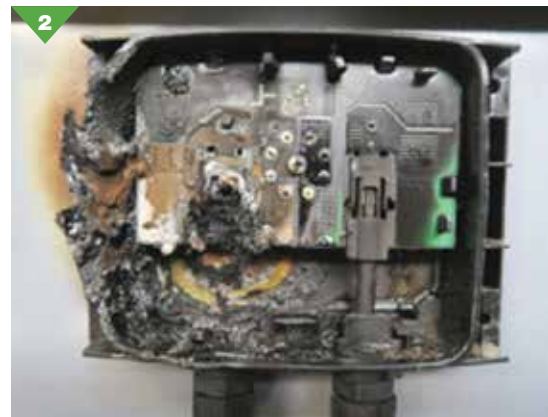
Korrodált érintkezők miatt bekövetkezett csatlakozódoboz égés
